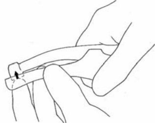
1. بينما تمسك إحدى اليدين بالتجميع ، تمسك اليد الأخرى بمنتصف مقبض الجهاز بالإبهام والأصابع الوسطى بينما تدفع رأس التوربين عبر الحلقة بإصبع السبابة لإخراجها من موقعها.
